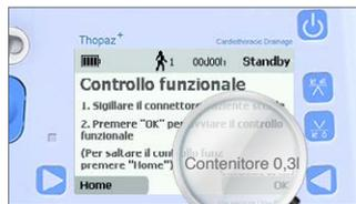
3. Verificare la dimensione del contenitore rilevato (rilevamento errato: scartare il contenitore)
